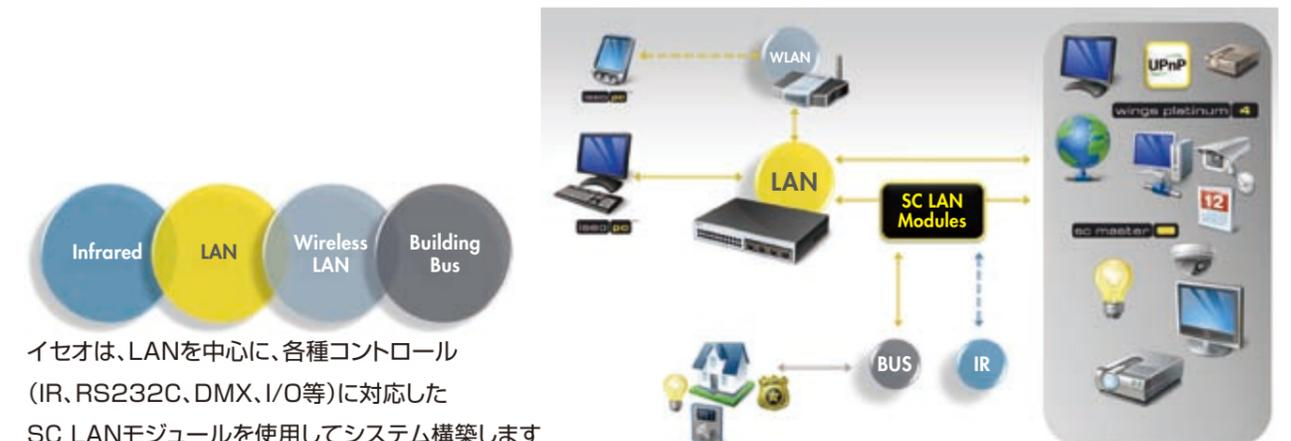
イセオは、LANを中心に、各種コントロール (IR, RS232C, DMX, I/O等) に対応した SC LANモジュールを使用してシステム構築します
