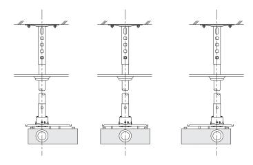
ご使用のプロジェクターの仕様に合わせ取り付け 穴加工し出荷いたしますので、レンズ芯とパイプ 芯を合わせることができます。
