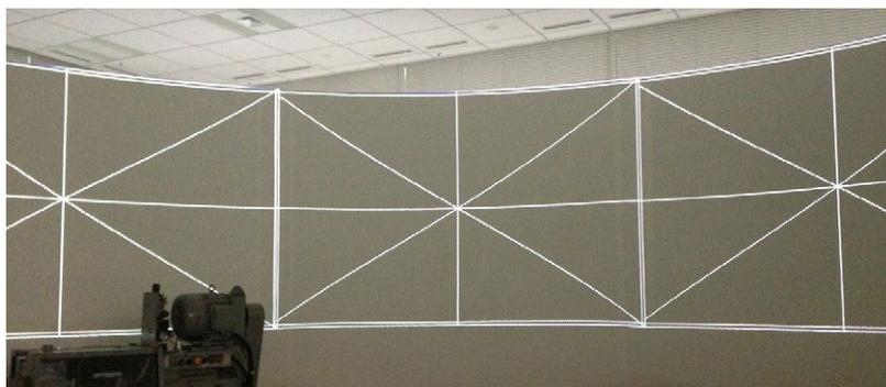
R壁に曲面補正とブレンディング処理をして横幅10mの映像を投射。普段は待機映像が流れ、来客者がゾーンに入るとリモコンでコンテンツを再生します。その際には照明も連動します。また、新商品発表などのプレゼン用途も考え、持込PC映像を映し出すことも可能です。
