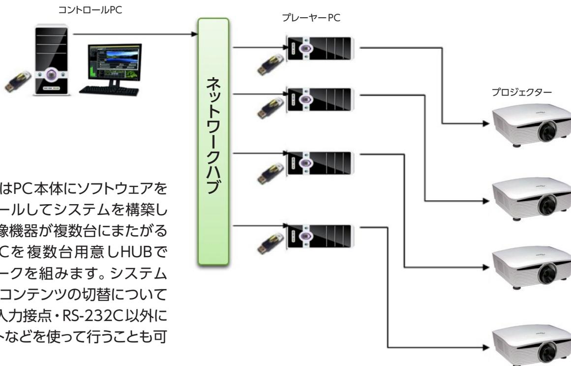
基本的にはPC本体にソフトウェアをインストールしてシステムを構築します。映像機器が複数台にまたがる際にはPCを複数台用意しHUBでネットワークを組みます。システムの起動やコンテンツの切替については、外部入力接点・RS-232C以外にタブレットなどを使って行うことも可能です。
