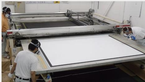
国内最大級のシルク印刷機で印刷されるスクリーンの黒マスクは、マスクラインのにじみや曲がりが大幅に軽減された、エッジの効いた仕上がりになります。塗膜の厚さも均一で、品質の安定と仕上がりの美しさには定評があります。この技術はタペストリーやブラインドへの印刷にも適しており、大判印刷についてのご相談を承ります。
