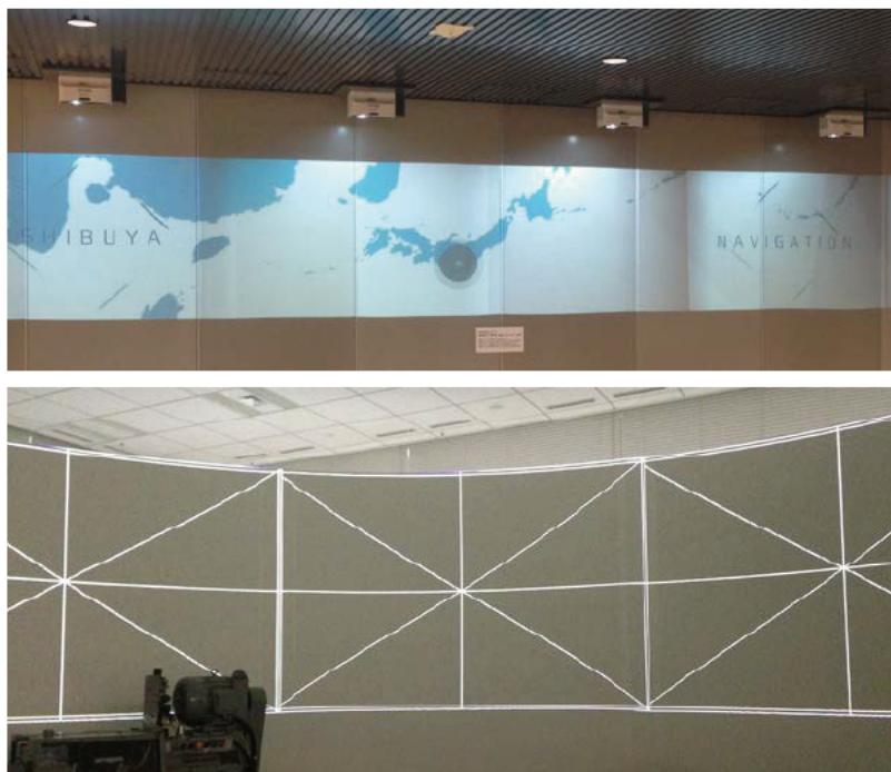
R壁に曲面補正とブレンディング処理をして横幅10mの映像を投映。普段は待機映像が流れ、来客者がゾーンに入るときリモコンでコンテンツを再生します。その際には照明も連動します。また、新商品発表などのプレゼン用途も考え、持込PC映像を映し出すことも可能です。
