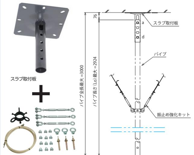
※DH-31A/AKは安全のため、a穴とd穴の2箇所固定します。
