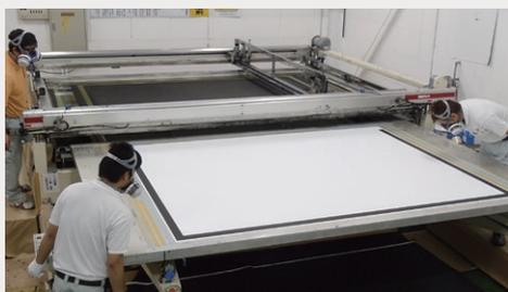
国内最大級のシルク印刷機で印刷されるスクリーンの黒マスクは、マスクラインのにじみや曲がり大幅に軽減された、エッジの効いた仕上がりになります。塗膜の厚さも均一で、品質の安定と仕上がりの美しさには定評があります。この技術はタペストリーやブラインドへの印刷にも適しており、大判印刷についてのご相談を承ります。
