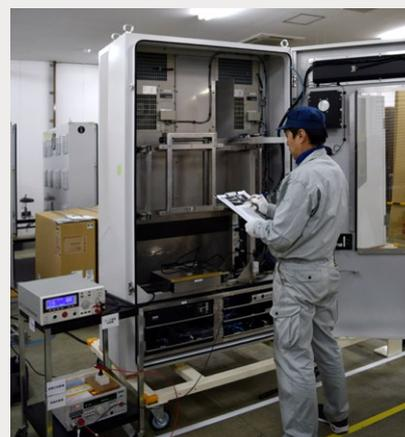
全ての工程を経て、最終試験は検査員により、1台1台厳正に行われます。製品の外観検査や完成品としての出来栄確認、各種電気特性試験が、決められた検査基準、検査手順に沿って行われます。
