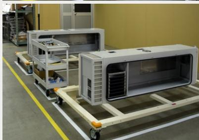
作業者の安全・作業性も考慮し、組み立て用台車等を自社設計しています。自社設計することでノウハウを蓄積し、他の生産工程への横展開を図る活動を行っています。
