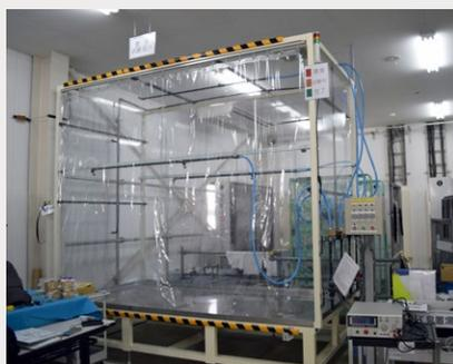
これまで、屋外で行っていた散水試験を屋内かつインラインで行えるよう、散水試験装置を自社設計しています。IP規格に沿った試験を全数行うことができ、検査プログラムは自動で進行する為、検査に要する工数の削減が実現できました。
