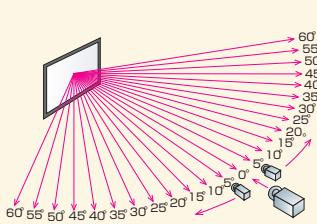
スクリーン生地が固有に持っている反射特性を数値で示したもので、スクリーンの特性を示す重要な要素となります。理論的には標準白板と呼ばれる完全拡散板(酸化マグネシウムを焼きつけた純白板)に光を当てたときの輝度を1とした場合、同一条件下でのスクリーン生地の輝度との比率を表しています。
