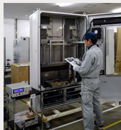
全ての工程を経て、最終試験は検査員により、1台1台厳正に行われます。製品の外観検査や完成品としての出来栄え確認、各種電気特性試験が、決められた検査基準、検査手順に沿って行われます。
