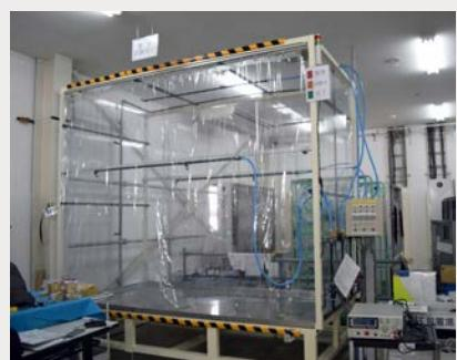
これまで、屋外で行っていた散水試験を屋内かつINLINEで行えるよう、散水試験装置を自社設計しています。IP規格に沿った試験を全数行うことができ、検査プログラムは自動で進行する為、検査に要する工数の削減が実現できました。
