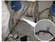
バトン昇降装置のワイヤー破損
