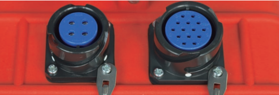
コネクター部：電源入出力（左）、シリアル通信及びリモート通信（右）
