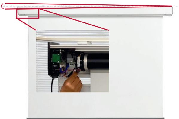
設置後のレベル調整が可能。内部の調整ねじ（うちわボルト）で傾きを微調整できます。壁・天井下地に歪みがあっても水平レベルが取れ、しわを予防します。
