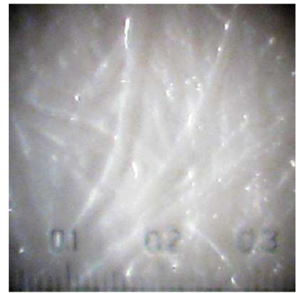
パルプの長い繊維が、高い平面性を確保 (上:顕微鏡写真)
