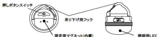
②スイッチを押す度に、以下のように照明用LEDが変化します。
