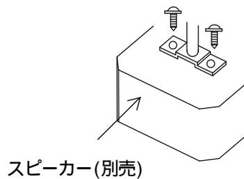
スピーカーを十字ねじまわしを使用し、ナベ頭ワッシャーヘッド小ねじ (M5) で固定します。
