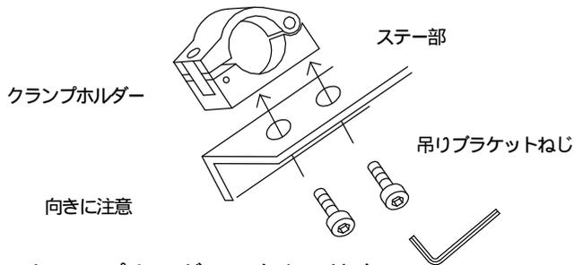
クランプホルダーの向きに注意し、吊りブラケットねじを六角棒スパナで締め付けます。
