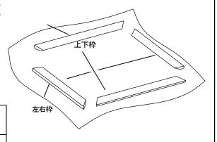
2) ①左右枠の溝(裏面)に合わせてL型金具を差し込みます。②次にコーナー固定金具を左右枠のスロットに差し込み、③上下枠と合わせます。
