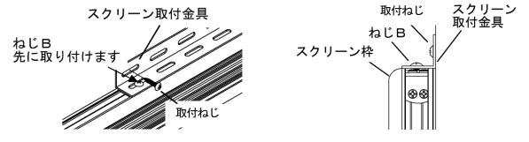
3) スクリーン取付金具を取り付けたスクリーンを壁面に取付ねじにて固定します。
