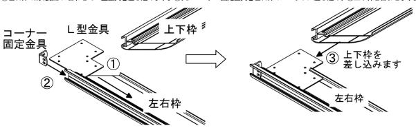
3) スクリーン枠の状態を確認しながら、L型金具とコーナー固定金具をねじ A で仮止めします。その後、対角の寸法差が無いよう調整し、①L
