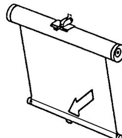
KA タイプはスクリーンを手で軽く引き下げてストッパーを外し、あとは手の届く位置まで手を添えて巻き戻し、手を離して自然に巻き取らせます。
