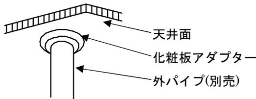
2. 確実に本体回転金具部を外パイプに差し込み、ボルト・ナット・ワッシャーで確実に固定します。
