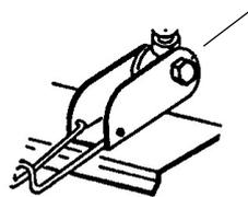
※傾斜装置は調整済みになっていますが、ディスクブレーキの効き具合を強くしたい場合は傾斜装置ボルトを締めてください。
