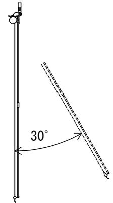
傾斜装置固定部より壁面まで最低必要寸法
