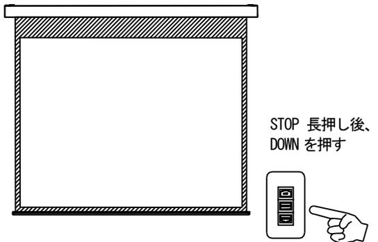
※注 〔DOWN■〕 ボタンを長押し、放置すると、工場で設定した位置まで自動的に下がり、止まります。
