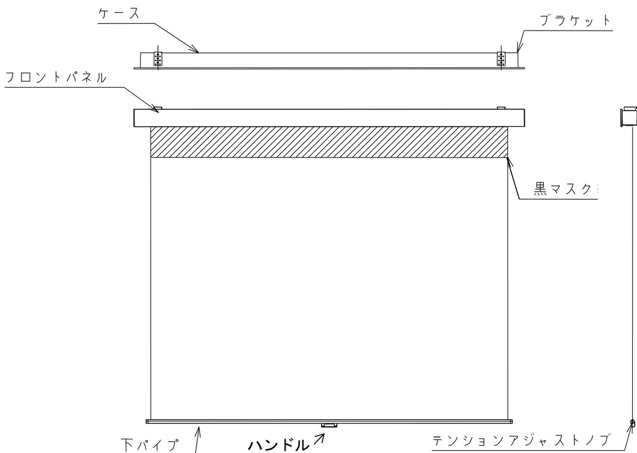
主材質：アルミニウム(フロントパネル、ケース、ローラー)/スチール(ケースキャップ他)/樹脂(キャップ類(ABS)、その他部品類(POM、PC))
