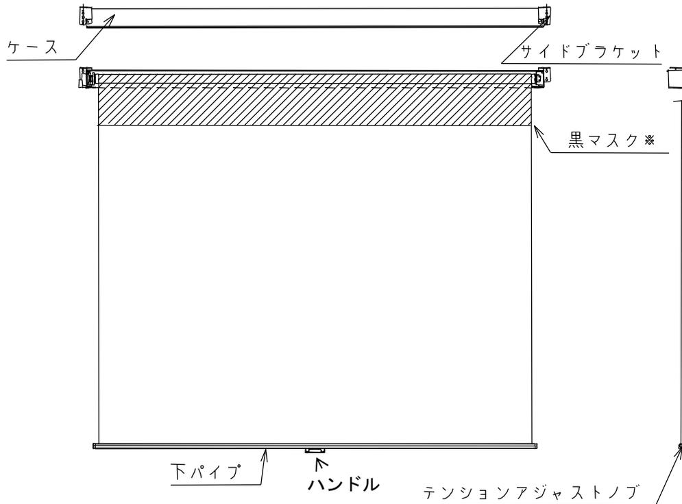
主材質：アルミニウム(ケース、ローラー)/スチール(ケースキャップ他)/樹脂(キャップ類(ABS)、
