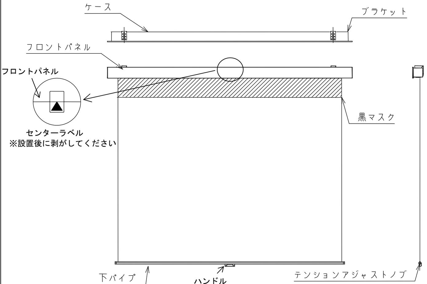
主材質：アルミニウム(フロントパネル、ケース、ローラー)/スチール(ケースキャップ他)/樹脂(キャップ類(ABS)、その他部品類(POM、PC))
