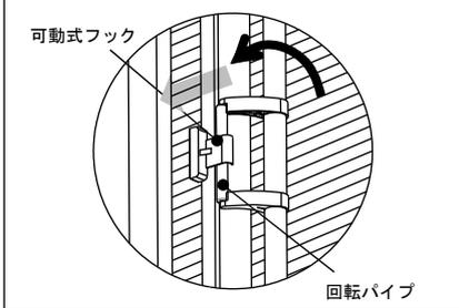
更に持ち手パイブを上げて回転させ、可動式フックから回転パイブを外します。
