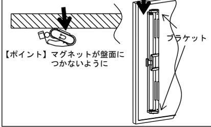
持ち手パイブを持ち、巻き取りローラーを盤面に押し当てます。
