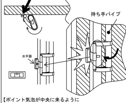
持ち手パイブを回転させ、可動式フック背面のマグネットをしっかり盤面に張り付けます。
