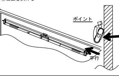
持ち手パイプを持ち、巻き取りローラーを盤面に押し当てます。
