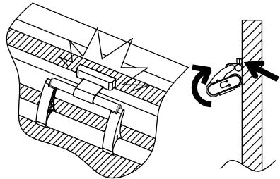
持ち手パイプを上に回転させ、可動式フック背面のマグネットをしっかり盤面に張り付けます。
