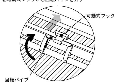
更に持ち手パイプを上げて回転させ、可動式フックから回転パイプを外します。
