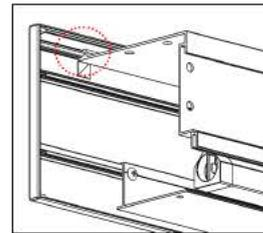
合わせたガイド部を支点にフロントパネルをスクリーンケース側へ押し込みねじ穴を合わせます。
