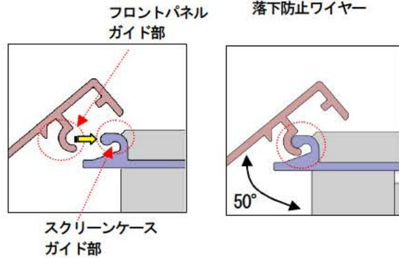
フロントパネル背面にあるパネル位置ラベルをスクリーンケース端と合わせます。
