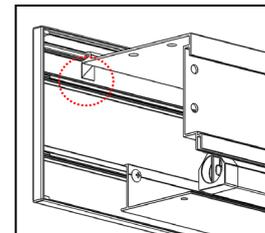
合わせたガイド部を支点にフロントパネルをスクリーンケース側へ押し込みねじ穴を合わせます。
