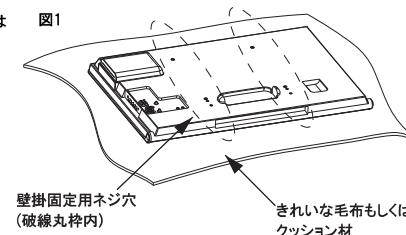
■本製品に付属しているディスプレイ取付金具をディスプレイ背面の壁掛け固定用ネジ穴に合せてください。
