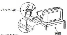
4. 1項で抜き取ったベルト部をクリップ部に差し込んで、 たるまない様に調整します。
