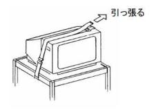
2. 引っ掛け金具部を天板側面に引っ掛けます。次に 反対側にも同様に引っ掛けます。 その際、テレビ形状に合わせてベルトの長さを 調節してください。
